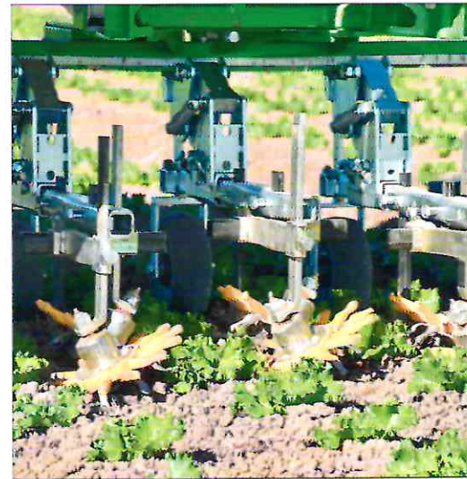
Unkraut hacken – hier am Dino von Naio – ist eine der Paradedisziplinen der Roboter.
