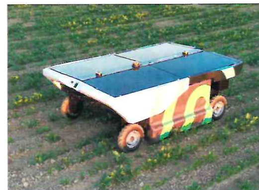
Aus der Schweiz kommt der Avo von Ecorobotix, er setzt weiter auf Herbizid, appliziert dieses aber in Mikrodosen nur auf die Unkrautblätter. Die Technik gibt es auch als reguläres Anbaugerät für Traktoren.
