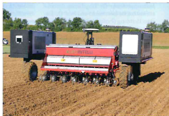
Der Robotti von Agrobotelli kann dank Dreipunkt mit regulären Maschinen umgehen. Er ist wahlweise mit 75 oder 150 PS (Kubota-Motor) zu haben.
