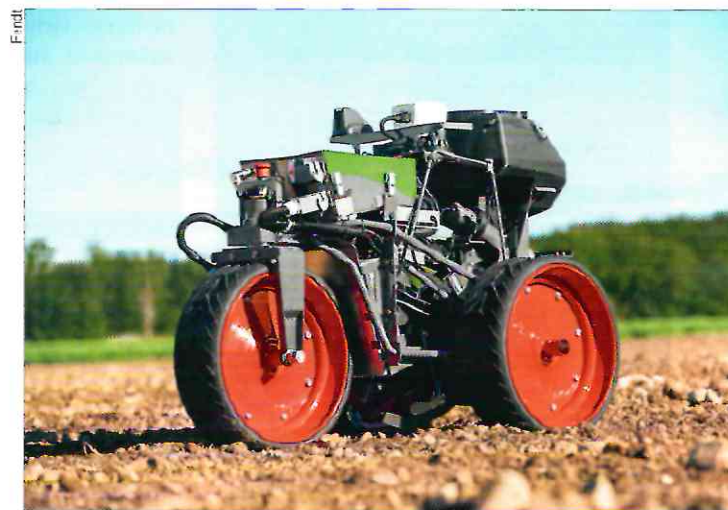
Der Xaver von Fendt wurde in der zweiten Generation praxisnäher, er sorgt für zentimetergenaue Saat. Das hintere Rad sorgt dabei auch für die nötige Rückverfestigung.
