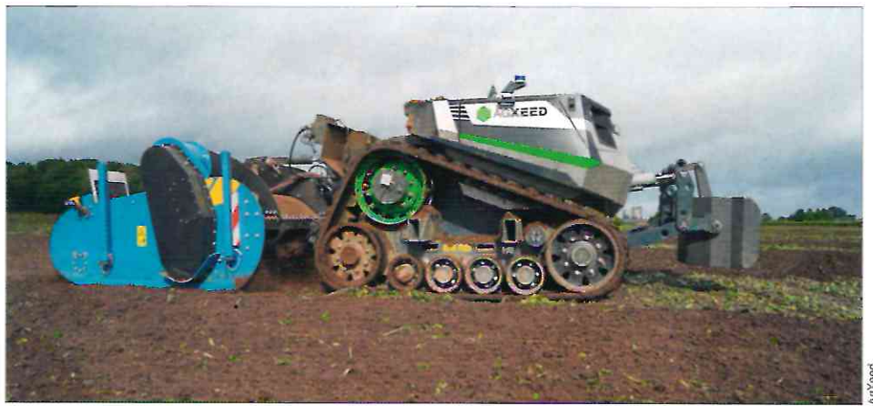
Das von Claas unterstützte Start-up AgXeed setzt auf größere Systeme mit über 150 PS und sechs Tonnen Eigengewicht. Damit ist auch Bodenbearbeitung möglich.
