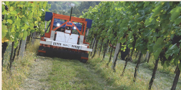
Robotski vinogradniški traktor Slopehelper lahko različna dela v vinogradu opravlja povsem samostojno in brez prisotnosti človeka.
