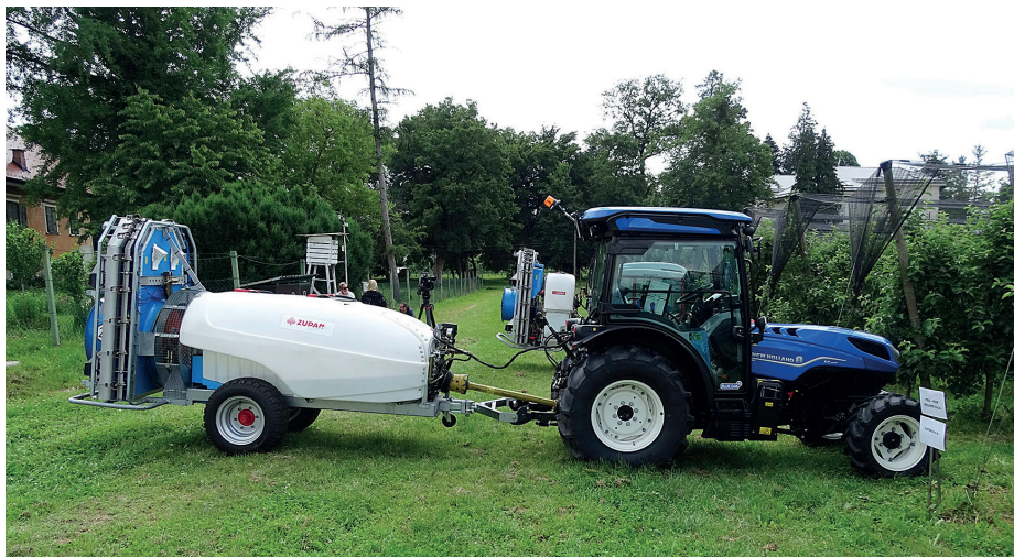
Ozokolotečni traktor New Holland T4 100 F in Zupanov vlečeni elektrostatični pršilnik ZM 1500 DT MAXI – O. Traktor ima 73 kW (99 KM) nazivne moči.
