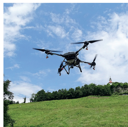
Z droni lahko tudi škropimo. Ta na sliki (Onedrone DJI AGRAS T) ima 10-litrski rezervoar za škropivo. V zraku pa je lahko tja do 10 minut.
