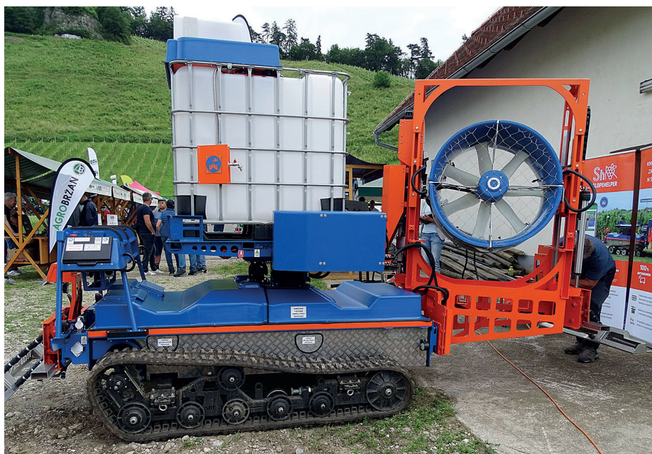
Slopehelper je slovensko avtonomno gosenično vozilo – robot, kjer ni več na stroju traktorista. Ima električni pogon in električno gnane priključke.
