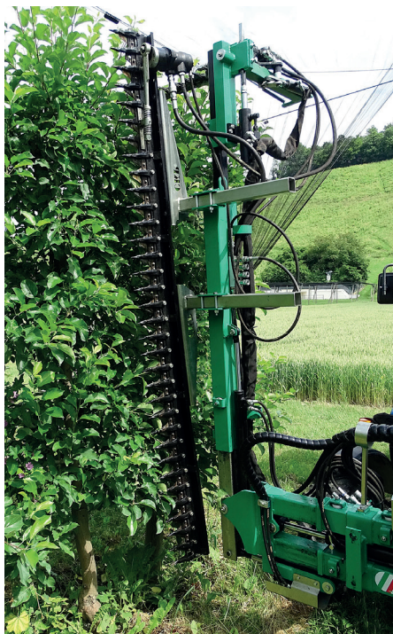
Mehanizira se tudi rez sadovnjakov, kar smo videli pri demonstraciji italijanskega strižnega rezalnika FAMA Pruning System CKP 250. Ta na sliki reže vertikalno steno in še vrhove (vertikalna in horizontalna kosa).
