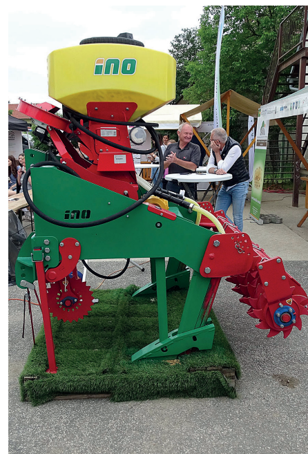
INO Brežice ima v proizvodnem programu tudi dvoredni vibracijski podrahljalnik s prigrajeno pnevmatsko APV napravo za dognojevanje v območje rahljanja tal.
