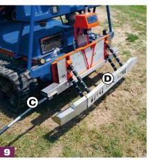
plicazione, realizza in continuo delle foto per documentare lo stato vegetazionale della coltura. In caso di rilevamento di un ostacolo, il robot si arresta e invia una notifica all'utente tramite TeroAir e attende le istruzioni dell'utente prima di riprendere l'operazione.
