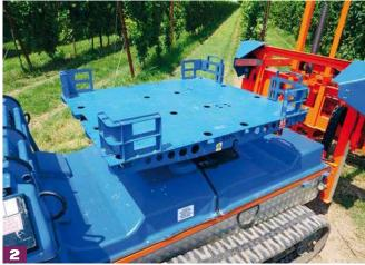
1. Il carro cingolato con nastri in gomma ha una superficie di appoggio di 0,87 m². A pieno carico (3.000 kg) lo SlopeHelper esercita una pressione sul suolo di 0,34 kg/cm². La struttura centrale tra i due carri ospita il gruppo batteria da 830 Ah (43 kWh)
