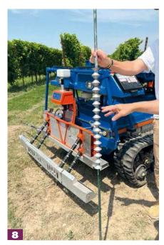
5. Il gruppo radar (A) posto sia anteriormente sia posteriormente al cingolato permette di rilevare in tempo reale la posizione del robot consentendo la movimentazione lungo il filare, indipendentemente dalla presenza del segnale satellitare. L'elemento GPS (B).
