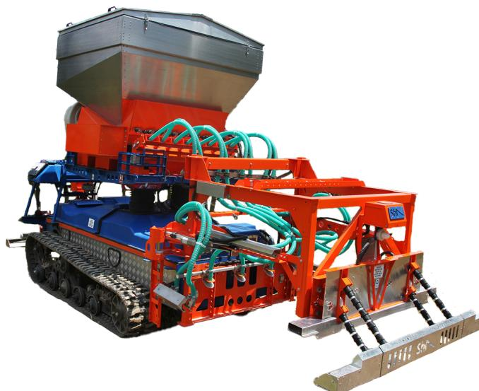
Il **Fertilizer di Slopehelper**, è innovativo sistema di fertilizzazione pneumatica. Progettato per un attacco incernierato, si compone di due moduli principali:
